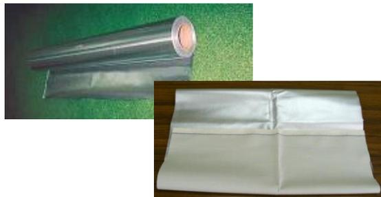
この特殊遮熱シートは、アルミ純度99%を使用した最大5層構造で、輻射熱を97%反射します。厚さも0.2mm～と超薄型を実現しており、熱源へ貼り付けることで熱源から出ている放熱を抑制(遮熱)、保温を行います。保温を行うことで熱源の省エネや温度が保ちやすくなり生産性アップにも寄与します。断熱材の場合、伝導熱を伝え、放熱してしまうが、本遮熱シートでは遮熱することで効果的な保温が可能です。
